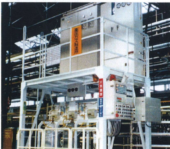
汽车空调用含氯氟烃的自动填充装置
