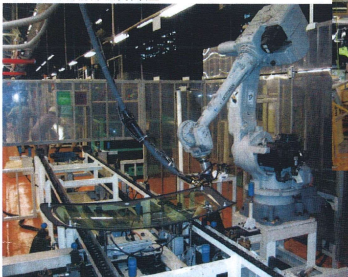
汽车玻璃黏合剂自动涂抹装置
