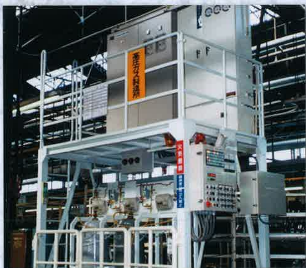
カーエアコンフロンガス自動充填装置
